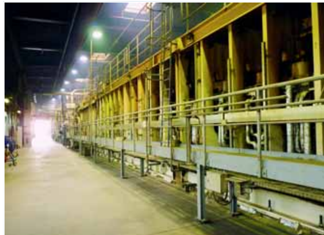
Oben: Die auf 38 m verlängerte Conti-Pressen von Siempelkamp
